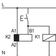
• Possibilité de commander, avec un même contact, le signal de commande sur la borne B1 et éventuellement, une charge en parallèle: relais, télérupteur etc...
